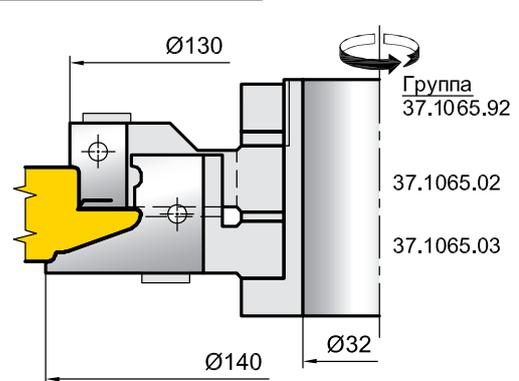
Примечание: \* По желанию заказчика комплект оснащается обкаточным подшипником для фрезерования фигурных деталей
